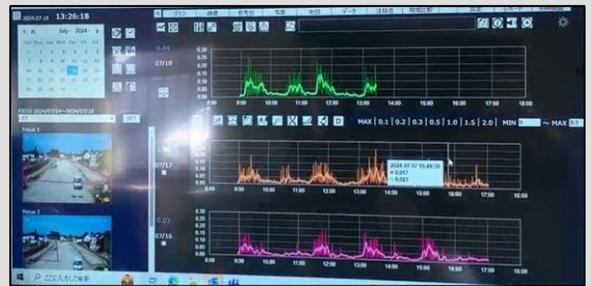
写真下: 波形の表示画面。各波形は日付毎。左側には、クラウドカメラの映像を映している。画像データを30秒ピッチで取得し、リアルタイムで波形を生成する。
