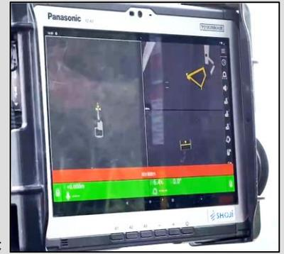
写真上: ディスプレイに刃先の座標や角度が表示され、重機オペレータはマシンガイダンスを見ながら作業が可能になる。
