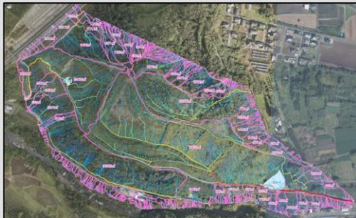
写真左:流域はピンク色、流路は水色で表示。点群から尾根を想定し、システムで範囲分けされる。流路は1cm四方の勾配に対して指定した流量を元に表示。窪地は雨水集水場所として表示。
