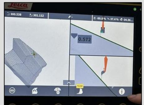
写真下: 運転席のモニターに表示されるマシンガイダンス画面
