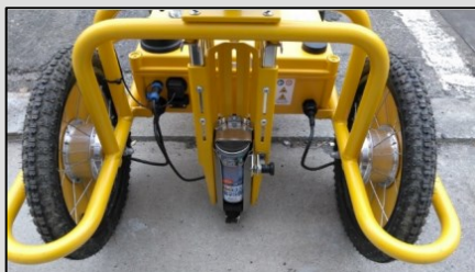
スプレー缶設置状況
